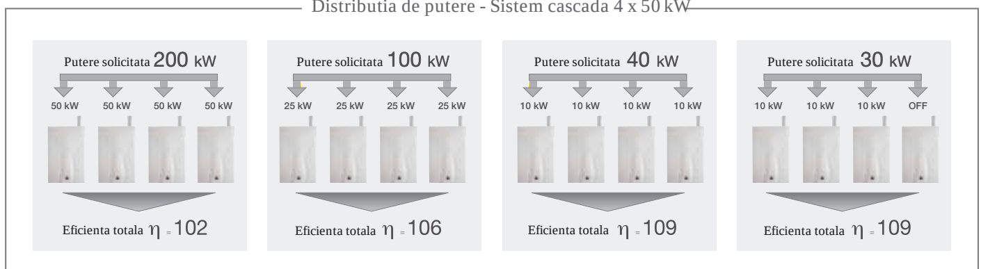
Distributia de putere - Sistem cascada 4 x 50 kW
